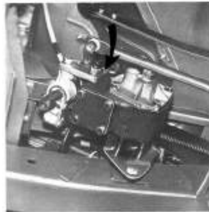
Figure 5 : Boîtier de direction, bouchon de niveau.
