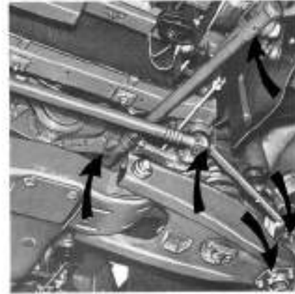
Figure 6 : Graisseurs pivots inférieurs et rotules de direction.
