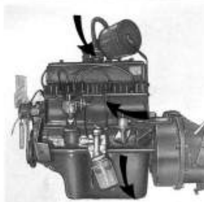
Figure 1 : Moteur essence, jauge à huile, bouchons vidange et remplissage.
