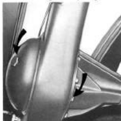
Figure 4 : Pont AR, bouchon de niveau et vidange.
