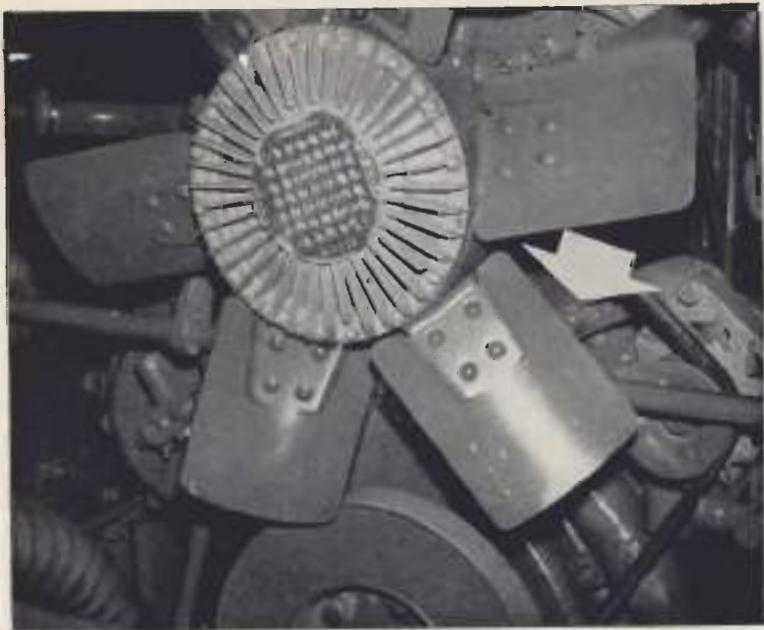
Fig. 2.15. - Tensado de las correas de mando del ventilador, bomba de agua y alternador
