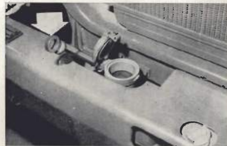
Fig. 2.9. - Varilla nivel aceite
